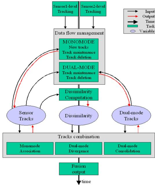
Fig. 2: schema fusion module
